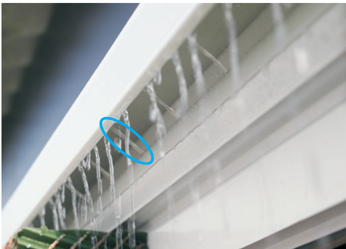
Profil atas dengan pipa berlubang dan deflektor untuk distribusi air yang merata pada pad
